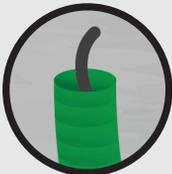
Il est préférable de prévoir l'aiguillage des gaines et fourreaux avant l'intervention de raccordement (une ficelle permettra au technicien de tirer la fibre). Le technicien pourra aussi tirer la fibre dans une goulotte prévue à cet effet par vos soins.
