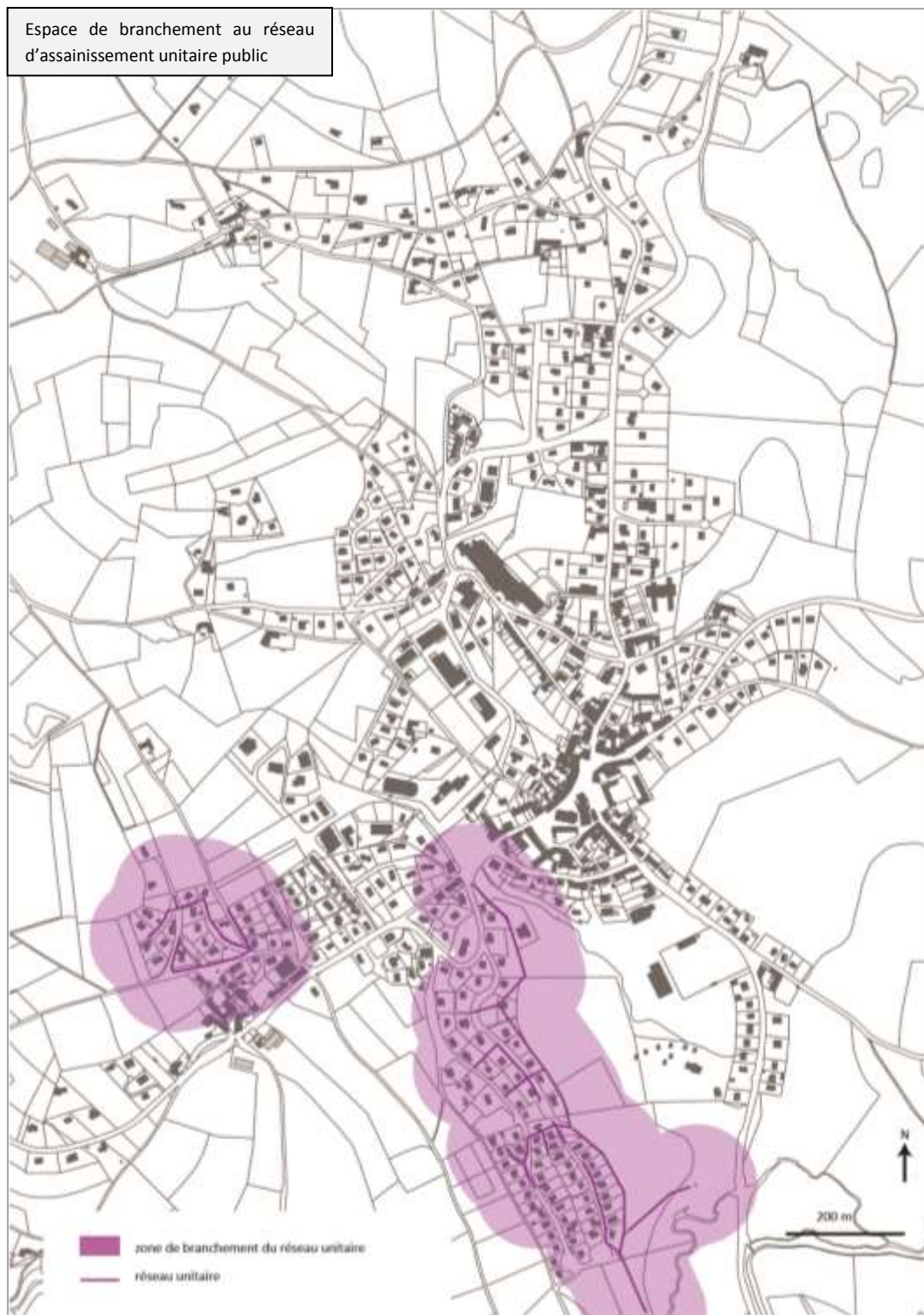
Espace de branchement au réseau d'assainissement unitaire public, (Bemo Urba et Infra)
