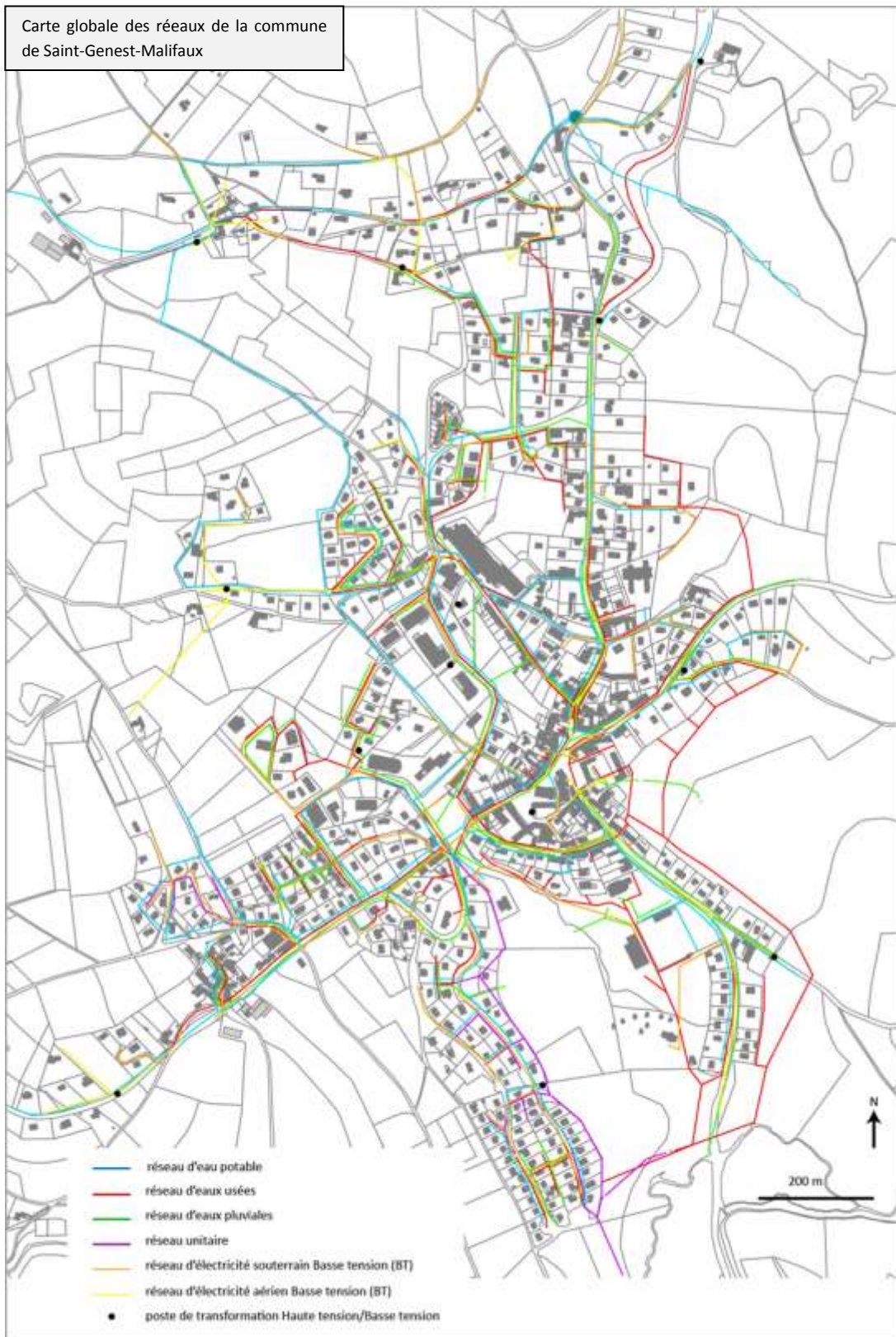
Carte globale des réseaux de la commune de Saint-Genest-Malifaux, (Bemo Urba et Infra)
