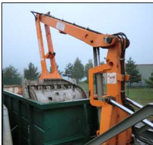
Compacteur à déchets de type PACKMAT
