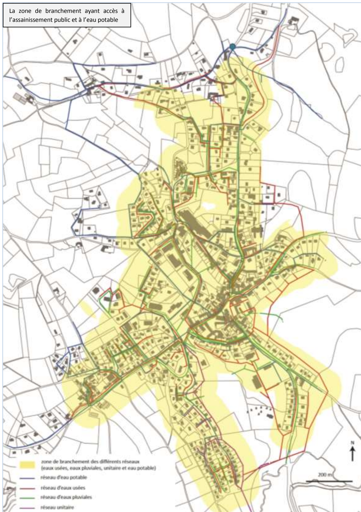
La zone de branchement ayant accès à l'assainissement public et à l'eau potable, (Bemo Urba et Infra)
