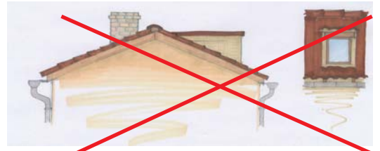
Ouvertures non intégrées à la pente du toit
