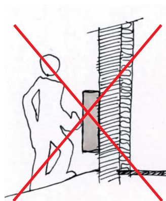
Élément non intégré à la façade
