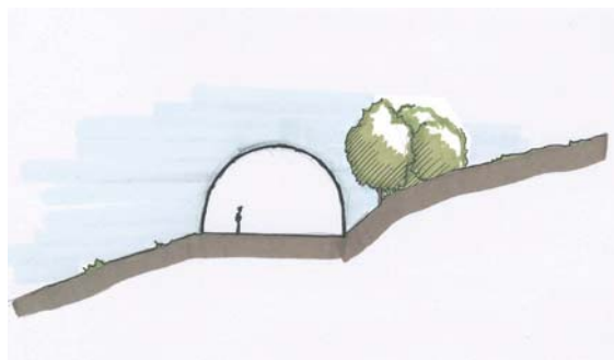
Tunnel agricole sur une plante-forme en déblai, adossé à une haie plantée
