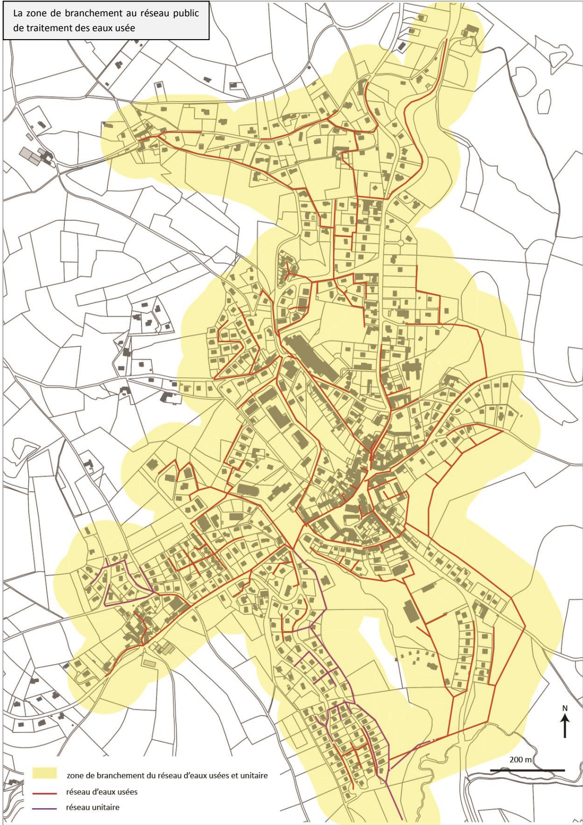
La zone de branchement au réseau public de traitement des eaux usée, (Bemo Urba et Infra)
