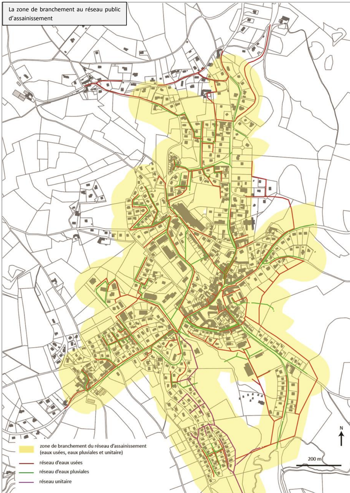
La zone de branchement au réseau public d'assainissement, (Bemo Urba et Infra)
