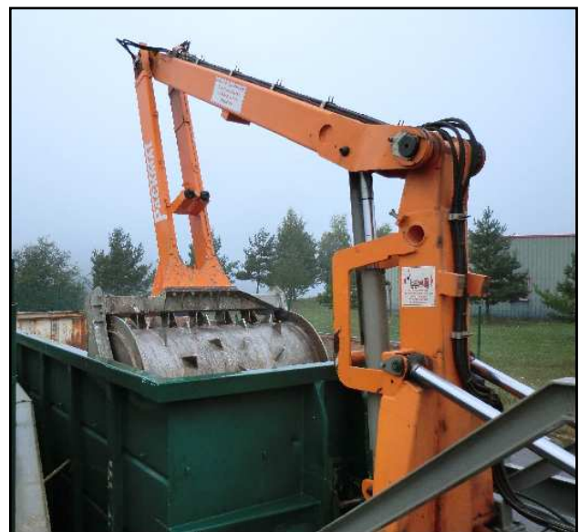
Compacteur à déchets de type PACKMAT
